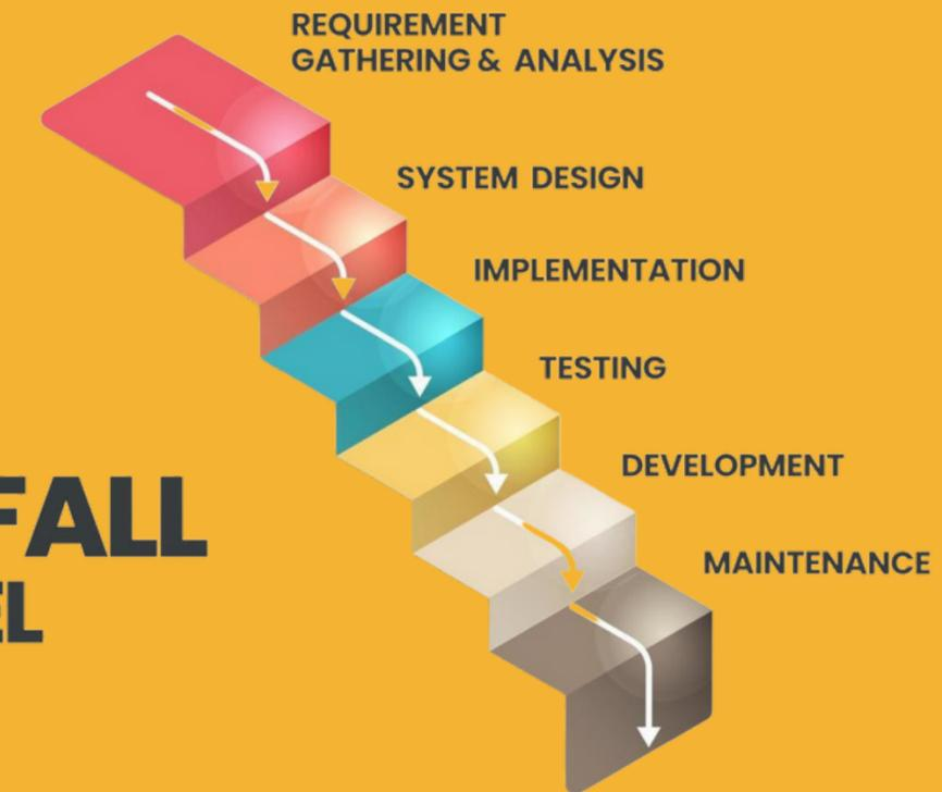
Consiste en desarrollar un proyecto de forma secuencial, comenzando con las fases de análisis y diseño y terminando con las de testeo y puesta en producción.
