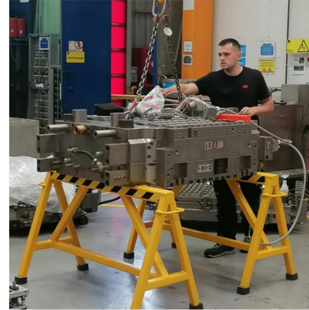
**Calibración molde de inyección**
